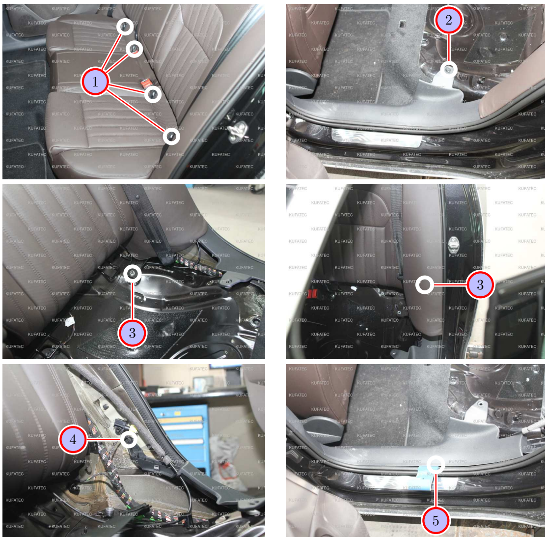
Abbildung 7: Demontage Verkleidung Fahrerseite hinten
